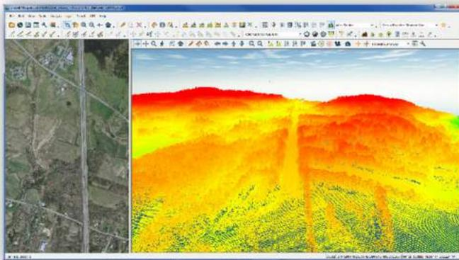
Los datos LiDAR se importan utilizando el procedimiento de importación estándar (Ctrl + O), pero el cuadro de diálogo de opciones de importación posterior es exclusivo de este formato. En esta ventana, los datos pueden ser filtrados, muestreados y, si es necesario, se pueden reticular directamente, evitando la necesidad de procesar los datos de puntos.
