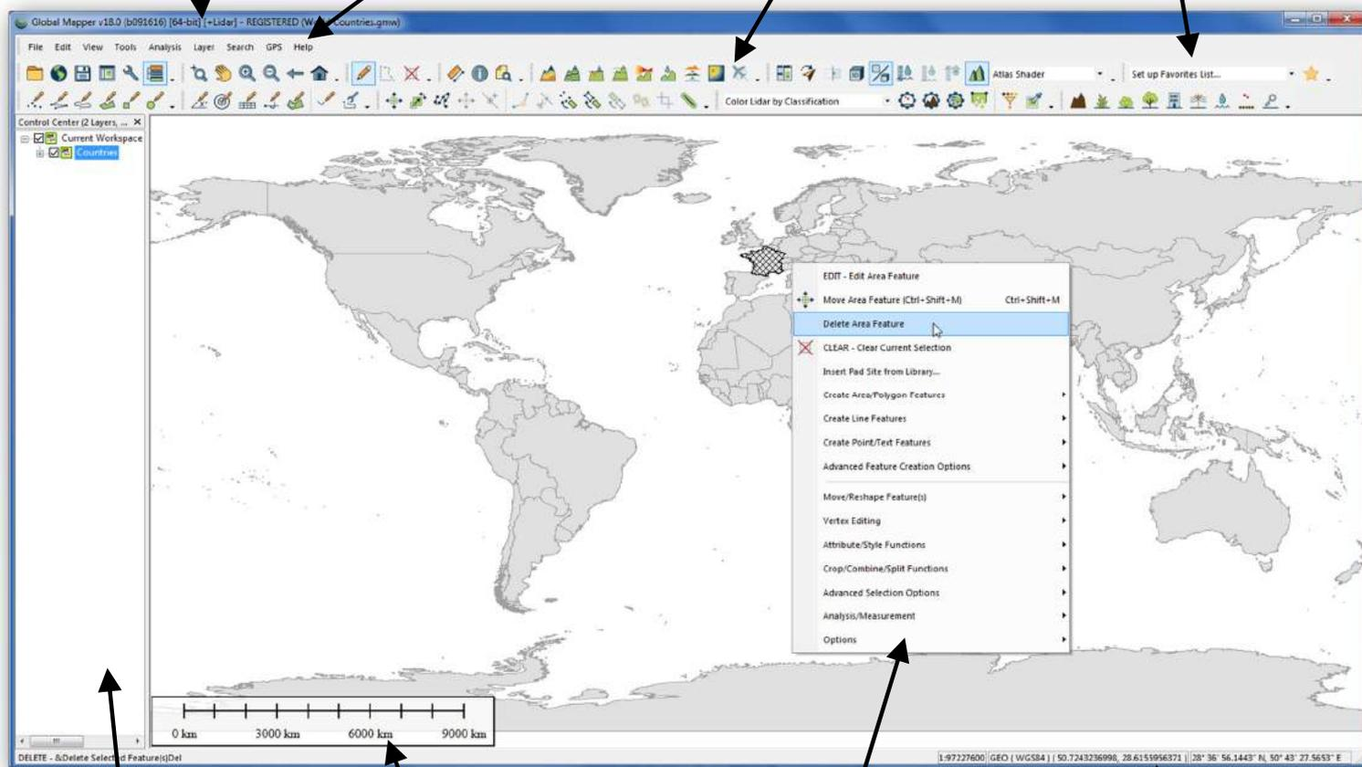
El **Centro de Control** de superposición despliega todas las capas cargadas y permite que se apliquen determinadas configuraciones a estas capas.
