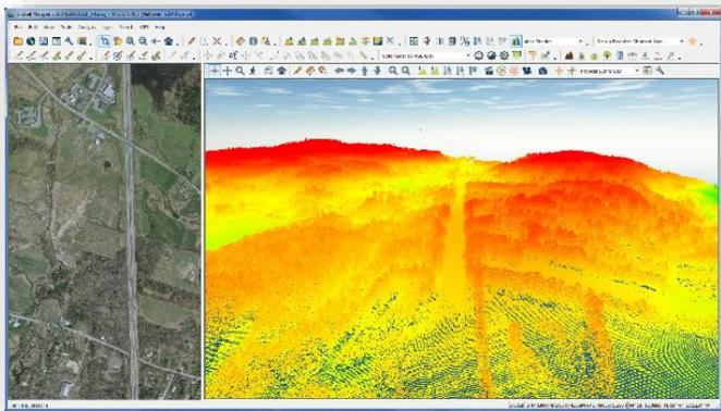
使用标准导入程序（Ctrl + O）导入LiDAR数据，但随后的导入选项对话框对此格式是独特的。在这个窗口中，可以对数据进行过滤，采样，如果需要，可以直接网格化，避免渲染点数据。
