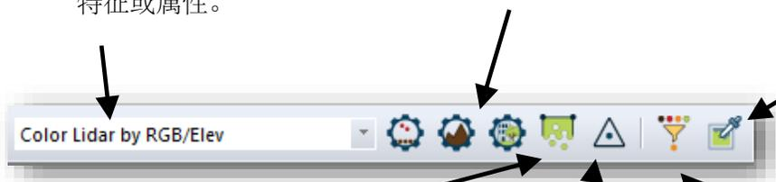
**提取矢量要素** 工具可从合适分类的点云图层创建三维建筑多边形和树木
